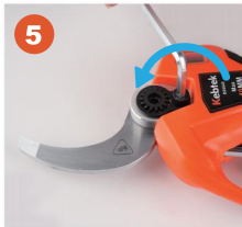
5. Retirer le petit écrou hexagonal intérieur.
