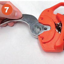
7. Remplacer la lame inférieure.
