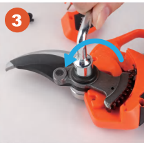
3. Retirer l'écrou hexagonal extérieur.
