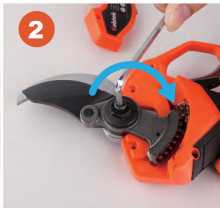
2. Retirer l'écrou hexagonal extérieur.
