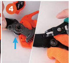
4. Retirer le clip, puis remplacer la lame supérieure.
